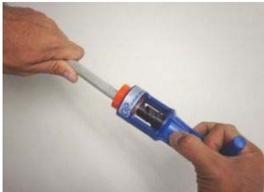
Figura 12. Preparadora de cable y cable coaxial sin chaqueta
